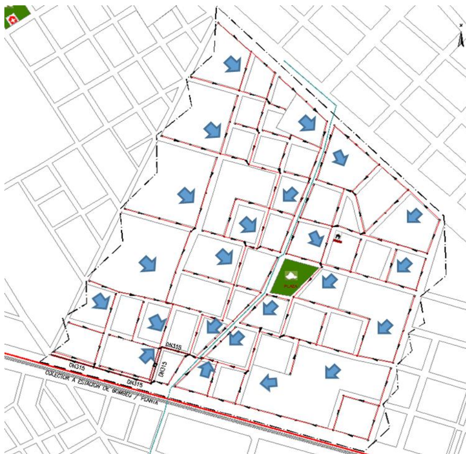
Ilustración V-3: Red Cloacal Interna – Zona 4
